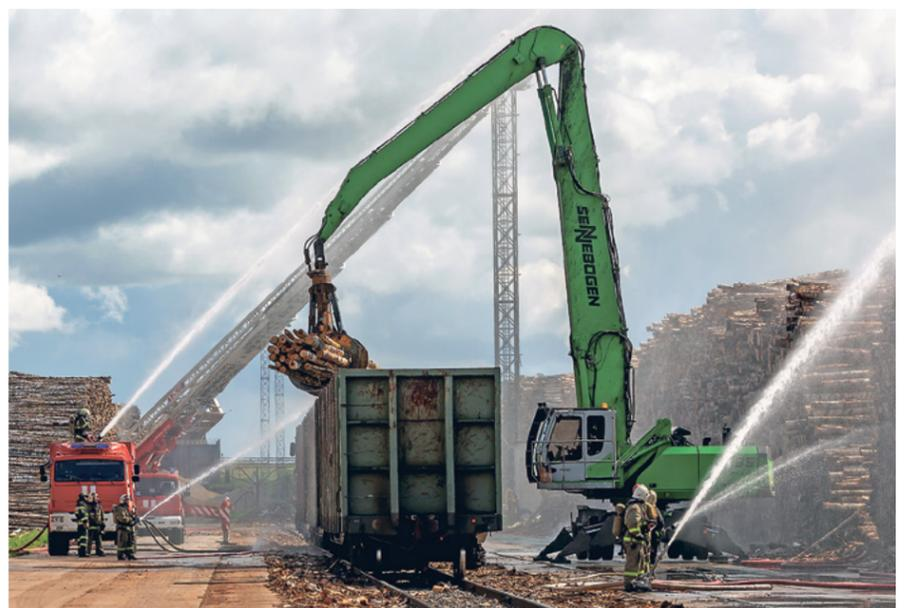
Чтобы остановить распространение огня, с помощью погрузчика в штабеле брёвен делают разрыв
